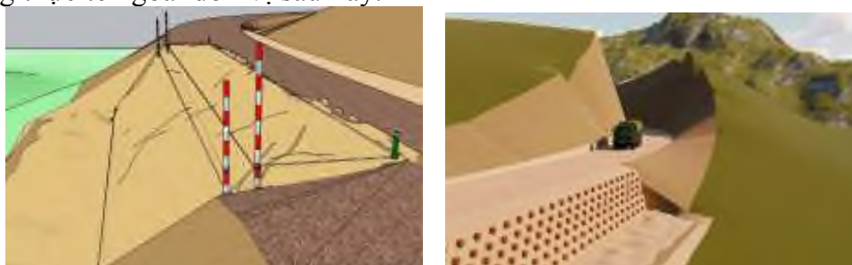
Hình 6: Mô phỏng phác họa và xây dựng kè gỗ xếp
